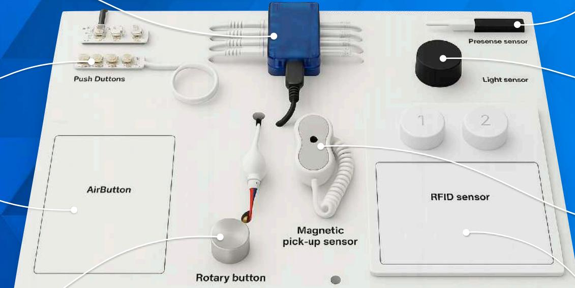
Detecta la **presencia o movimiento** de una persona frente al display. Permite activar pantallas, luz o sonido automáticamente.
