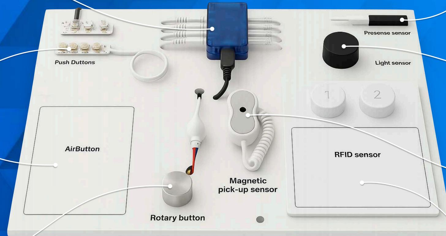
Detecta la **presencia o movimiento** de una persona frente al display. Permite activar pantallas, luz o sonido automáticamente.
